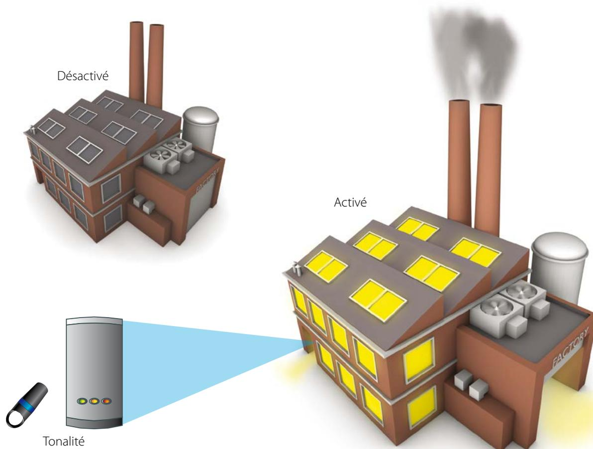
Lorsqu'une télécommande valide est présentée au lecteur, la carte Net2 I/O peut activer l'alimentation électrique d'un éclairage, chauffage ou autre appareil électrique, selon la programmation.
